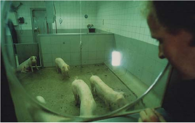
動物飼育室的窺視窗設計成半球面體，人員在走道探視動物可有大角度之視野。
