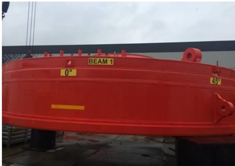
IHC 打樁機(Hydro Hammer)所使用的固定套環
