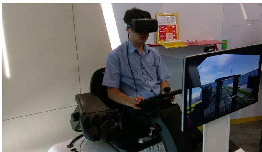
圖 7 虛擬實境操作遠端堆高機作業
