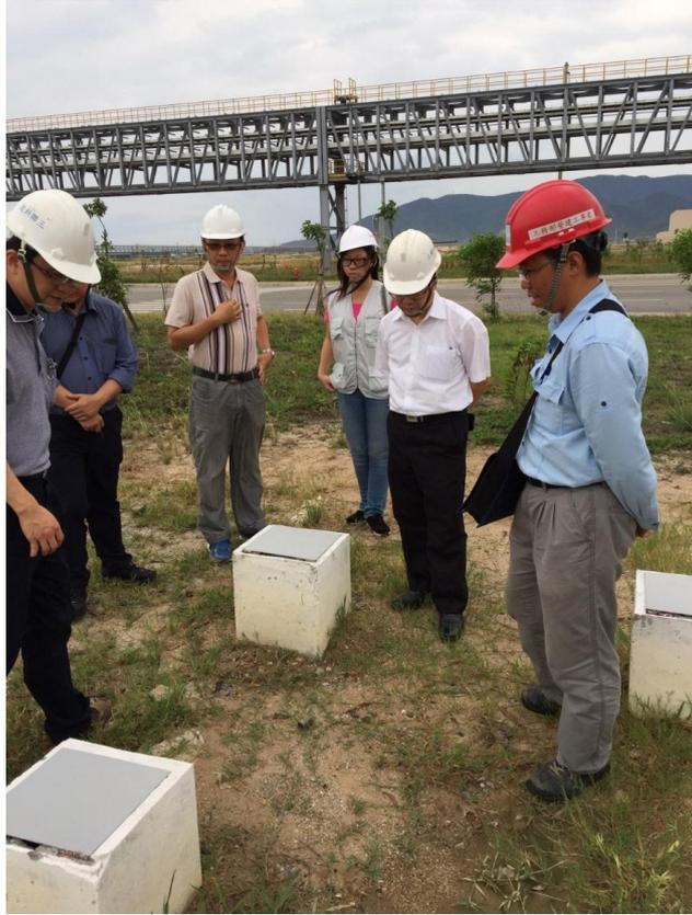
圖 10、控制點固定樁檢視
