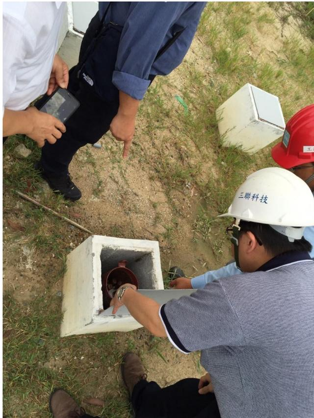
圖 11、沉陷監測儀器檢視
