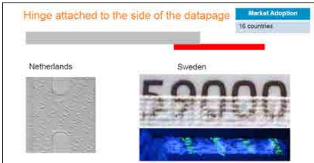
圖 169 採用圖中紅色的材質將資料頁的邊緣和紙張結合
