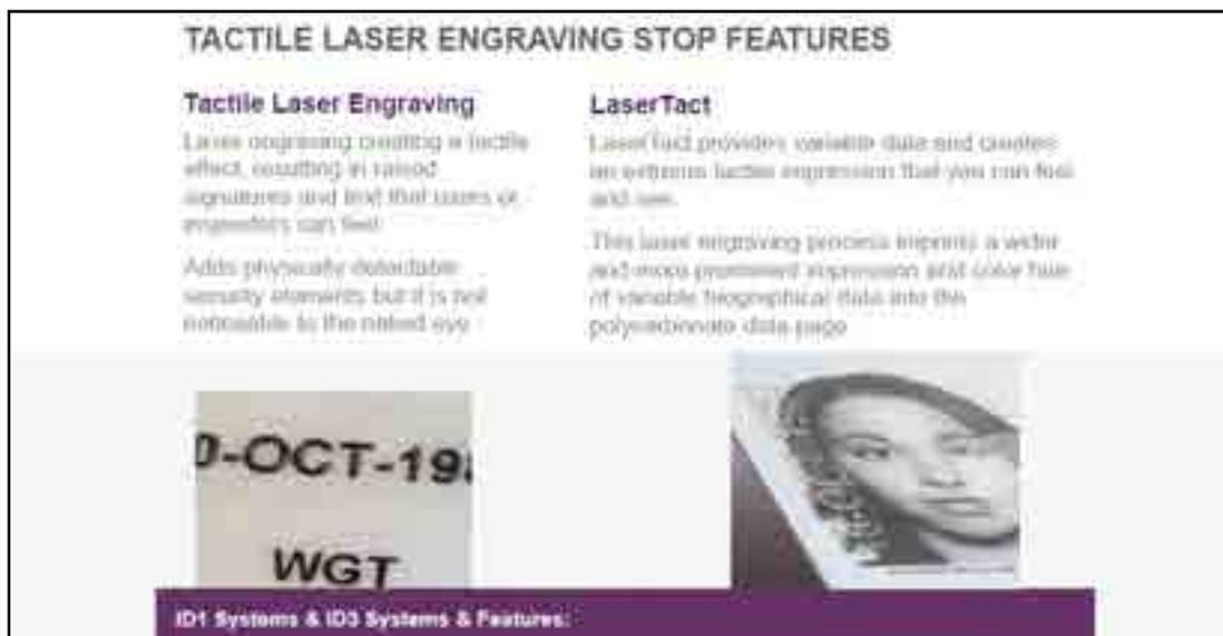
圖 141 採用雷射雕刻於 PC 材質上製造出浮凸特徵
