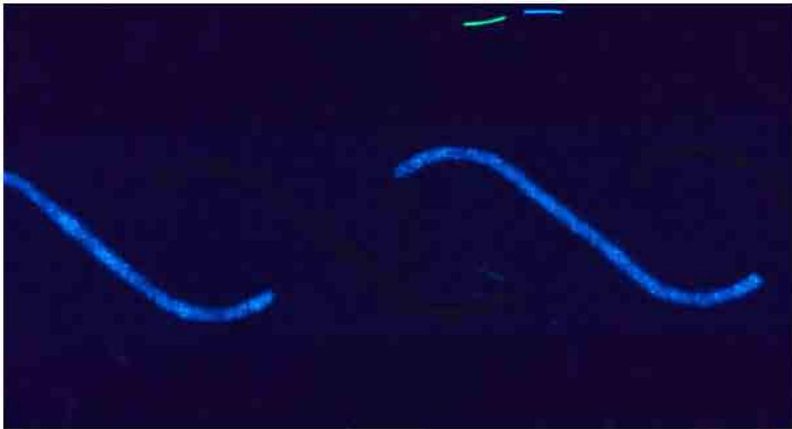
圖 84 西班牙 FNMT 紙張 UV 反應油墨於凸起觸感的印紋處
