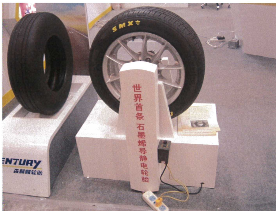
圖 7. 世界首條石墨烯導靜電輪胎—「森麒麟—華高墨烯」導靜電輪胎
