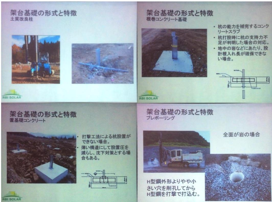
圖二十、支稱架基礎的型式及特徵實例說明
