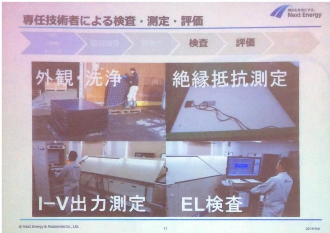
圖二十五、檢查及評價(外觀、洗淨、絕緣抵抗測定、I-V 出力測定、EL 檢查)
