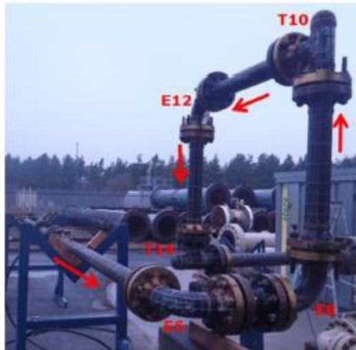
圖 1 Subramani 等人之管線出砂磨蝕現場試驗
