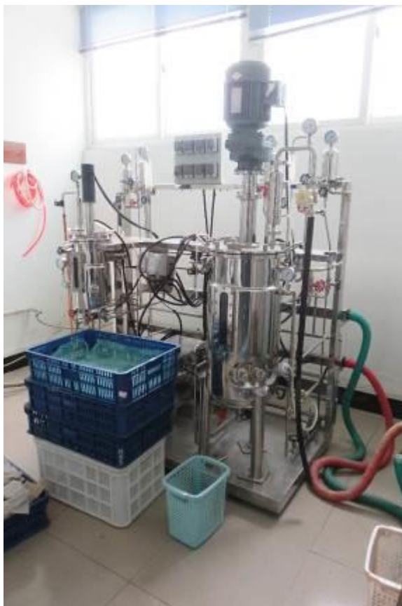
圖二十、生物農藥與化學生物學重點實驗室內用於研製生物農藥之發酵槽
