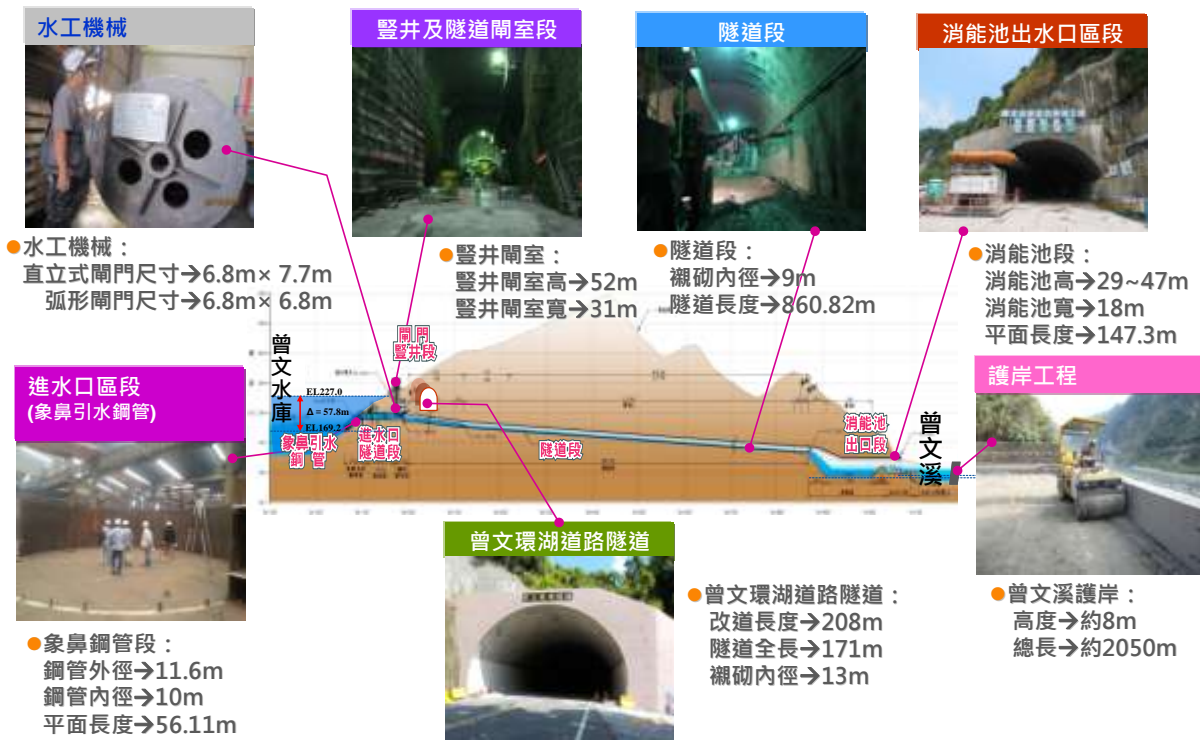
圖 3 曾文水庫防淤隧道工程示意圖(張世賢等，2016)
