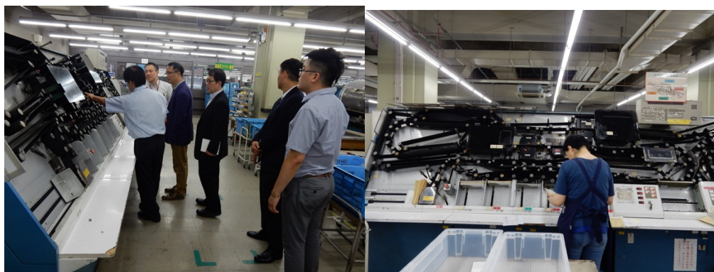
圖十二、Japan Post 豐島郵便局人員示範郵件如何利用分類機器進行自動分類
