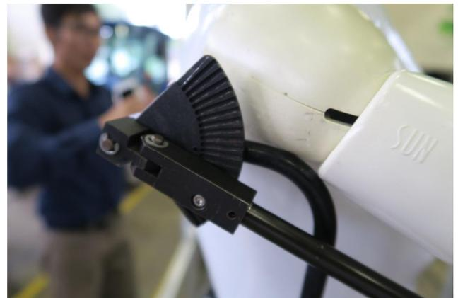
腕上作業輔助器具結構簡單不需使用電力
