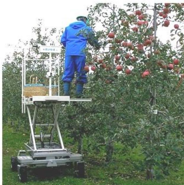
高空作業車田間操作情形
