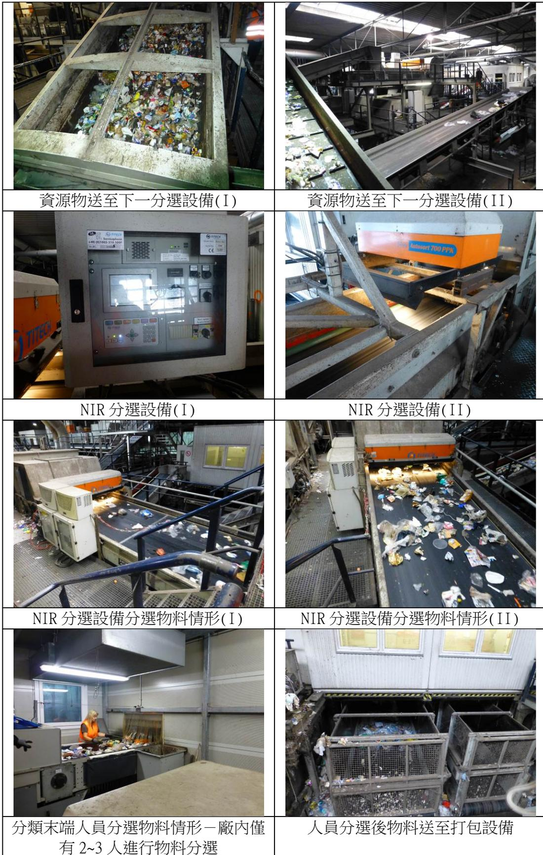
圖 3.3-2 波鴻回收類廠處理流程圖(續)
