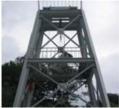
圖 13 9 公尺墜落測試
