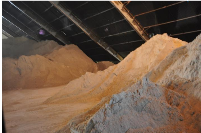
圖 6Lippe Plant 中待處理底灰
