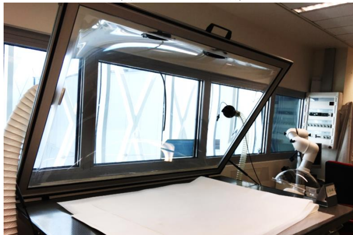
圖 3- 31 新館真空抽氣桌 (來源：自行拍攝)
