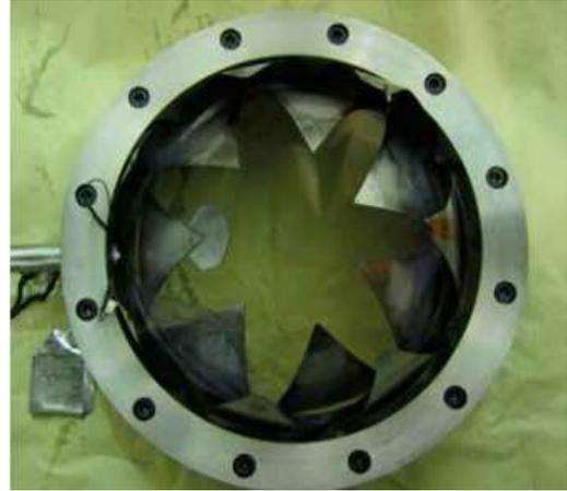
圖 3-2 破裂盤(右:已動作 左:正常 SERGI 工廠)
