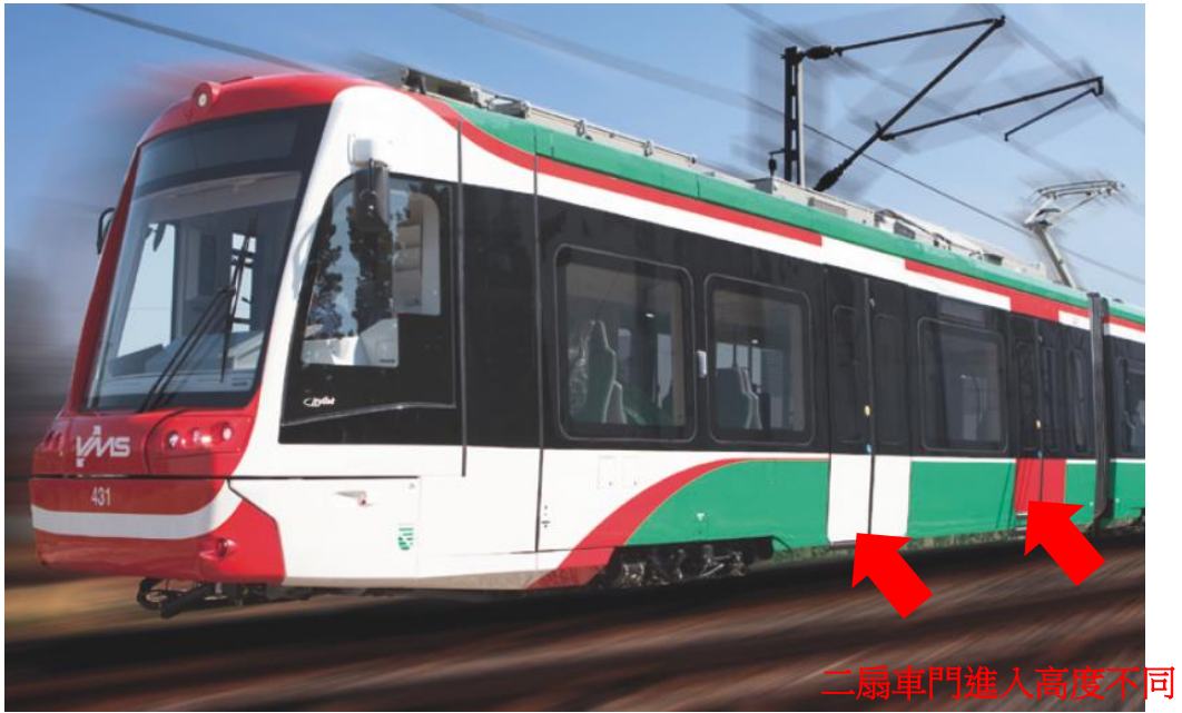
圖 3-8 Citylink Chemnitz 車門有二種不同進入高度
