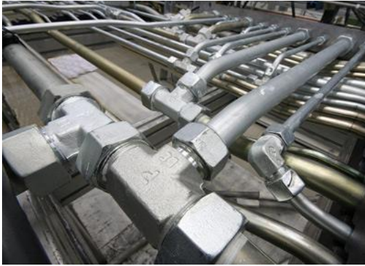
圖 3-41 機車內管道模組
