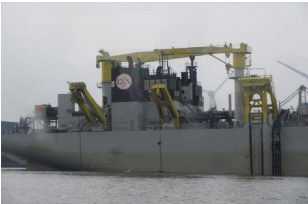
圖 3-25 浚泥船作業情形
