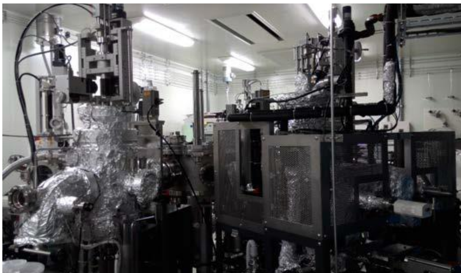
<圖一>沉積高介電係數氧化物的原子層沉積(ALD)儀器
