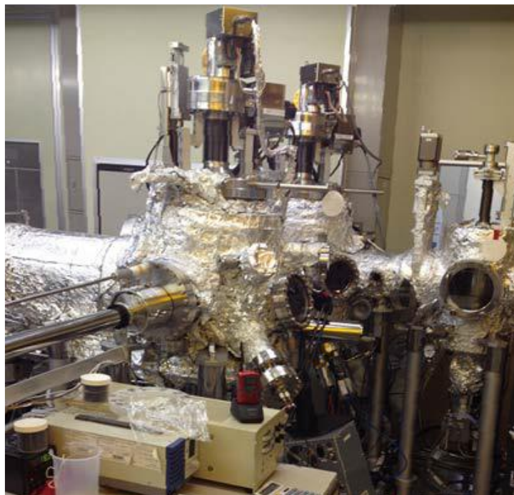
<圖二>分子束(MBE)氧化物沉積儀器
