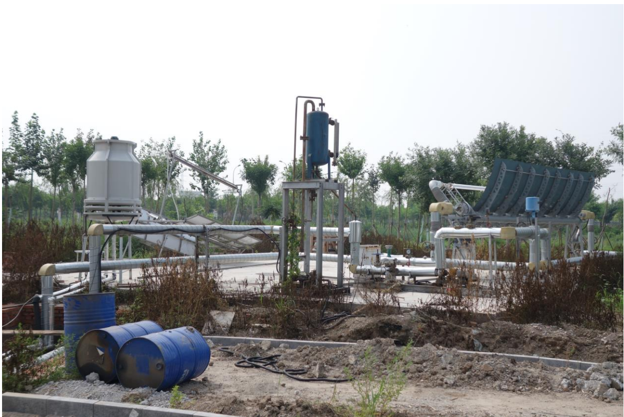
圖 4、7/29 天津大學機械工程學院研發建置 200kW 的有機朗肯循環 (Rankine) 太陽熱能發電系統原型
