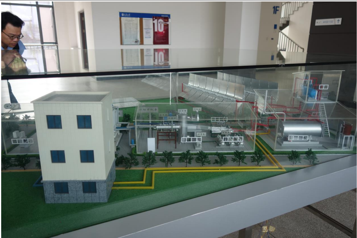
圖 3、7/29 天津大學機械工程學院研發建置 200kW 的有機朗肯循環 (Rankine) 太陽熱能發電系統模型
