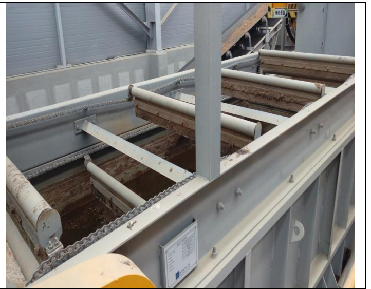
圖22_H-Plus 公司污染土壤清洗刮除機
