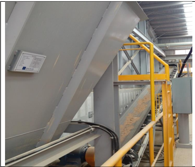
圖21_H-Plus 公司污染土壤處理分選機
