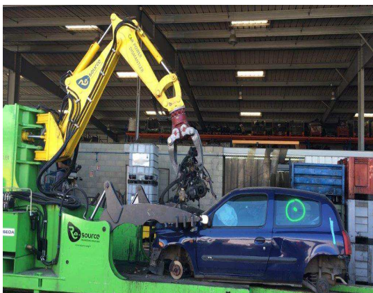
車內電線拆卸
