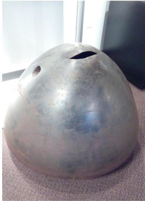
圖 8、反應器壓力槽底部實驗結果
