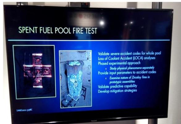
圖 6、用過核子燃料池耐火試驗介紹
