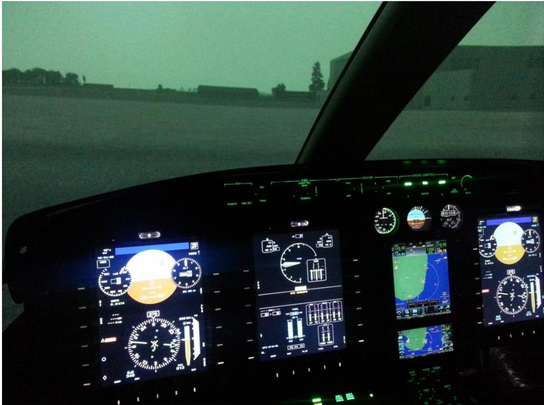
**【圖 49】**紐約市警察局航警小組配置一臺最先進的飛行模擬器，裡頭儀器設施及軟硬體皆與實體直升機相同，讓飛航官模擬任何飛行中可能面臨之狀況（如黑夜、閃電、暴風雨、龍捲風、引動故障等），累積經驗俾降低飛航事故
