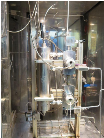
圖 10 岩心沖排試驗系統之三相分離器
