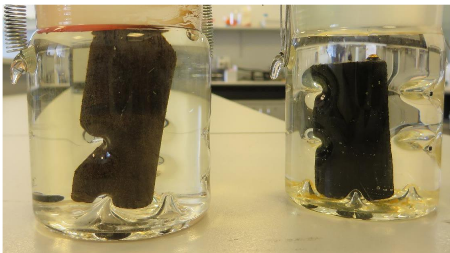
圖 13 B 礦區岩心浸泡於低礦化度鹽水(左)及高礦化度鹽水(右)之原油脫附情形
