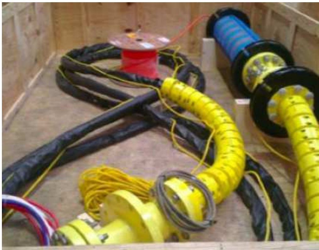
圖八 陽極接線防過度彎曲保護方式
