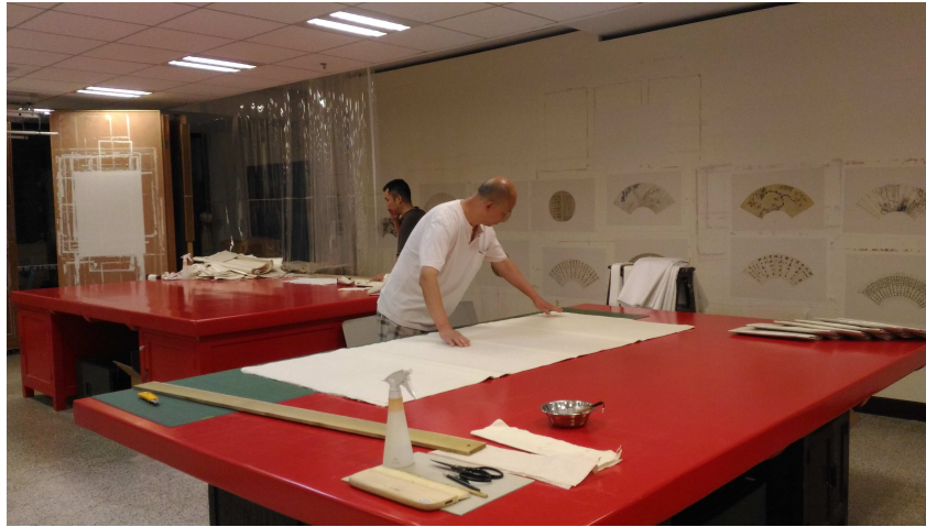
圖3.書畫碑拓專用工作桌，採傳統紅色桌面以利檢視紙張狀況，背面為以17層紙糊成之紙質裱板
