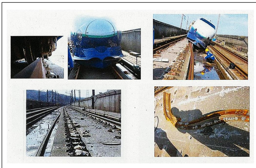
圖 31 2004 年新瀉地震造成上越新幹線列車嚴重脫軌
