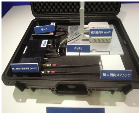
圖 22 災害現場使用 wifi、電子郵件暫存伺服器以及傳送至無人飛行器之天線等展示
