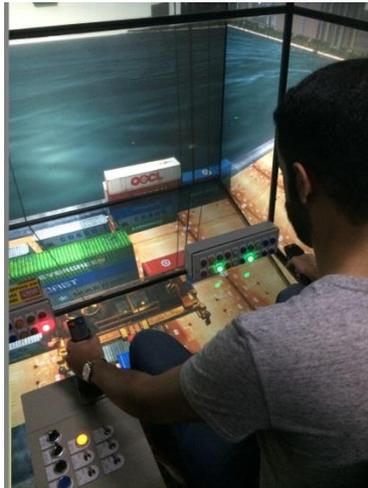
圖 19. 橋式起重機模擬操作
