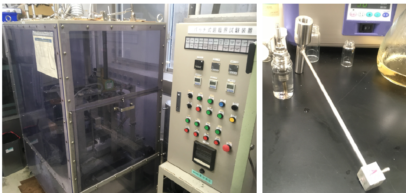
圖 15、批次超臨界/次臨界試驗裝置系統(左)與反應器(右)
