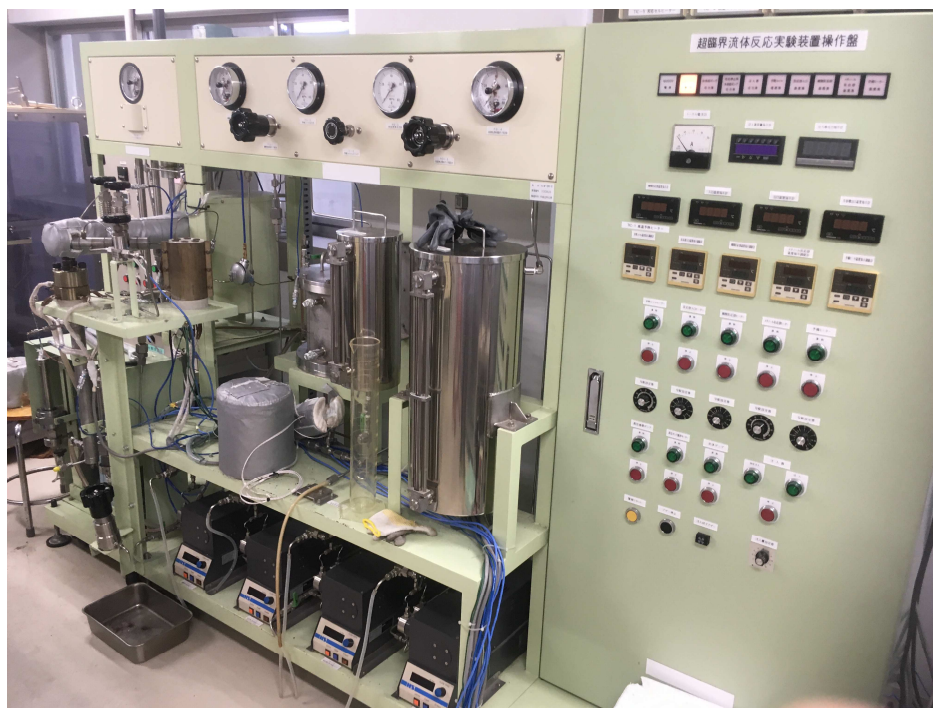
圖 17、超臨界流體反應實驗裝置(針對固液反應)
