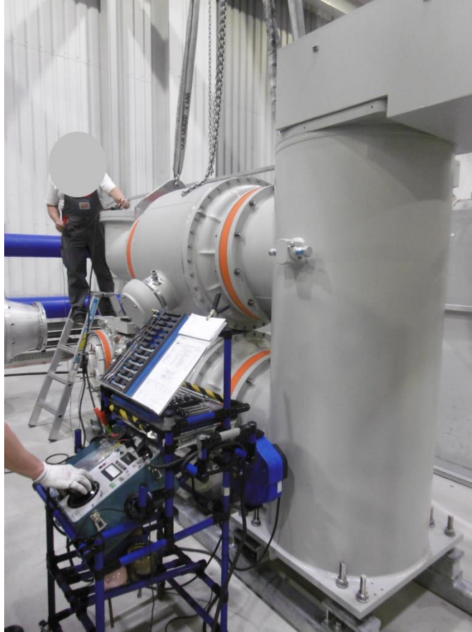
圖 9. 試驗人員操作氣體密封性試驗試驗紀錄
