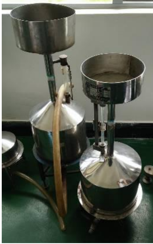
上圖為辦理油量計檢定用之金屬量器(又稱量桶)
