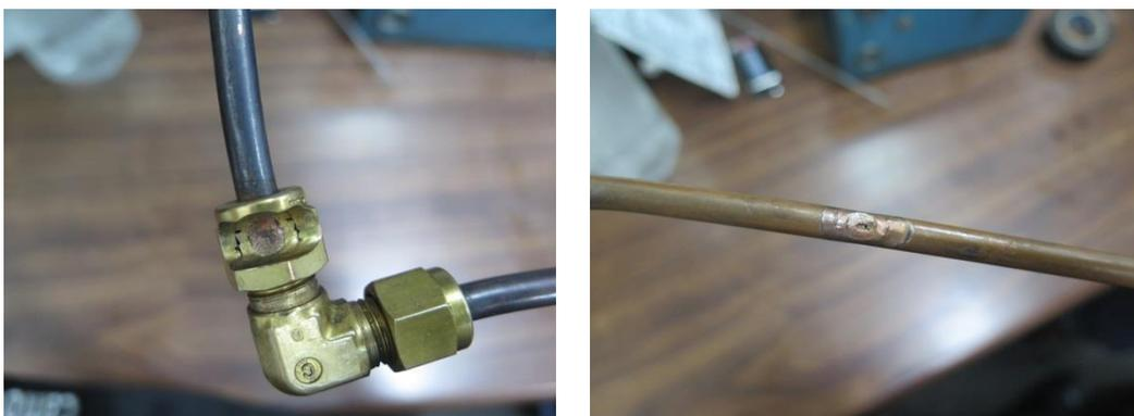
圖十八：氫氣盤內取樣銅管破損情況
