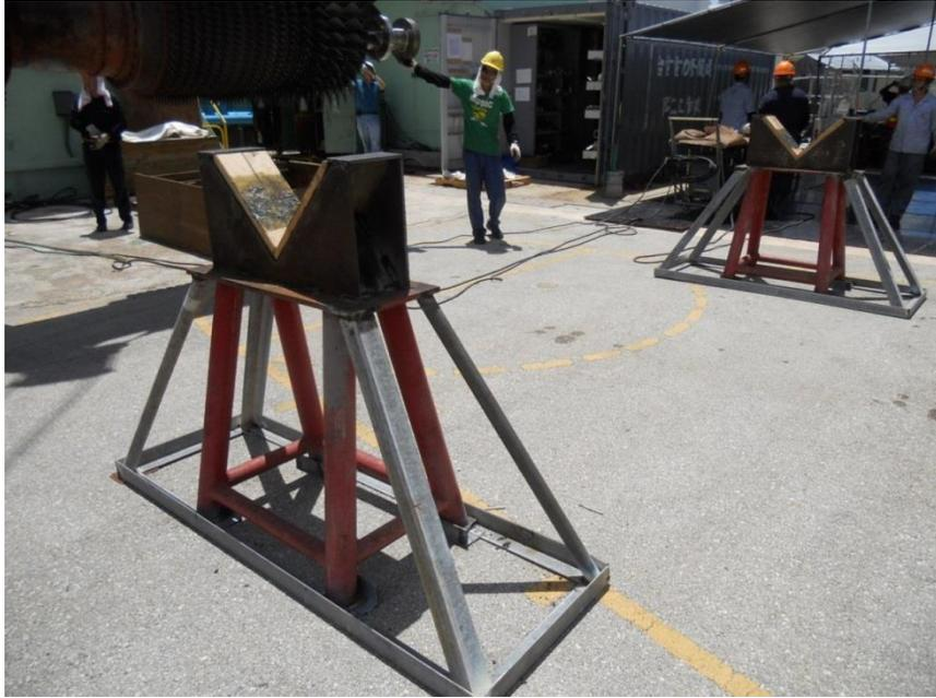
圖十六：轉子置放架、轉子吊掛架(此圖為 Piti 電廠使用)
