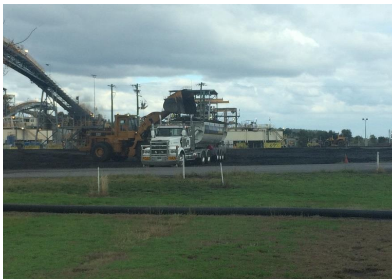
照片 3：鏟裝機裝載煤炭至側傾式卡車
