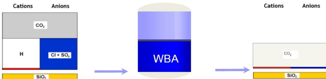
圖13. 弱陰離子交換樹脂(WBA)造水示意圖
