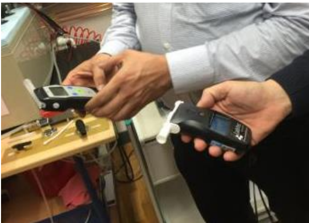
圖 實驗室人員示範簡便隨身型與定置型酒精呼氣測試計
