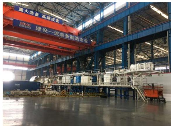
圖二十、隧道挖掘機之全長（一百公尺）
