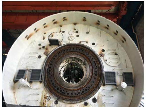
圖十八、隧道挖掘機之挖掘盤
