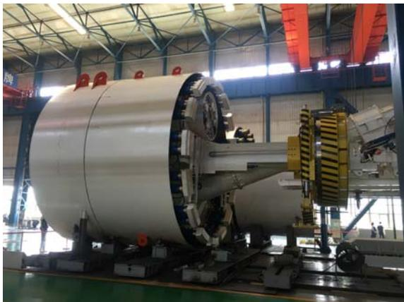
圖十七、隧道挖掘機之挖掘頭
