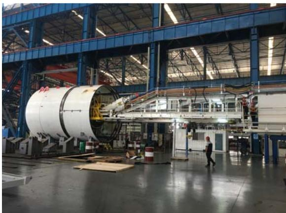
圖十九、隧道挖掘機之前段
