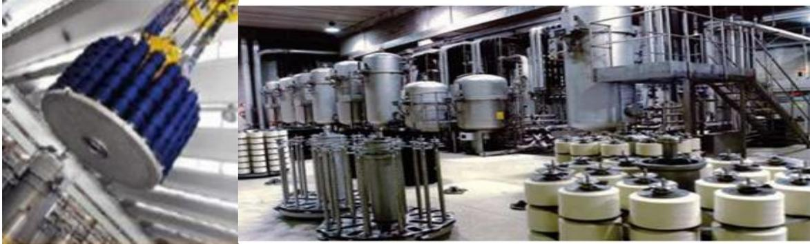
圖 6 G. Tosi 公司的自動化吊掛裝填系統及染色機
