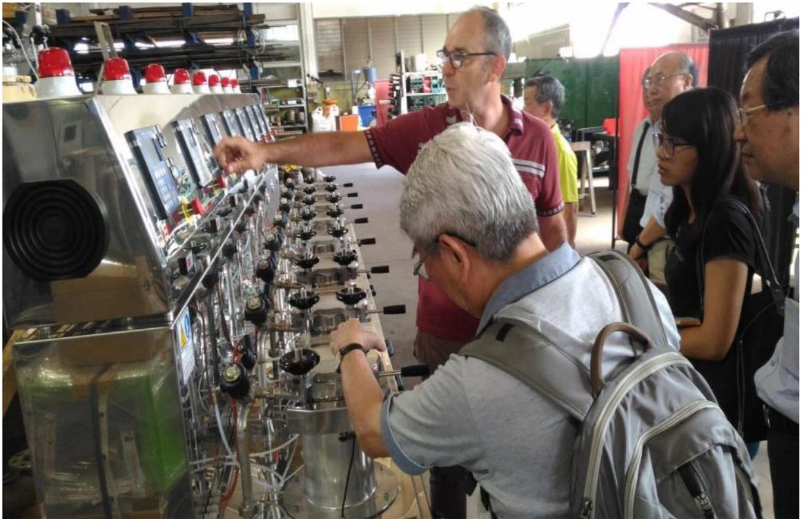
圖 15 團員實地了解 Ugolini 生產的小量布料染色機運作原理
