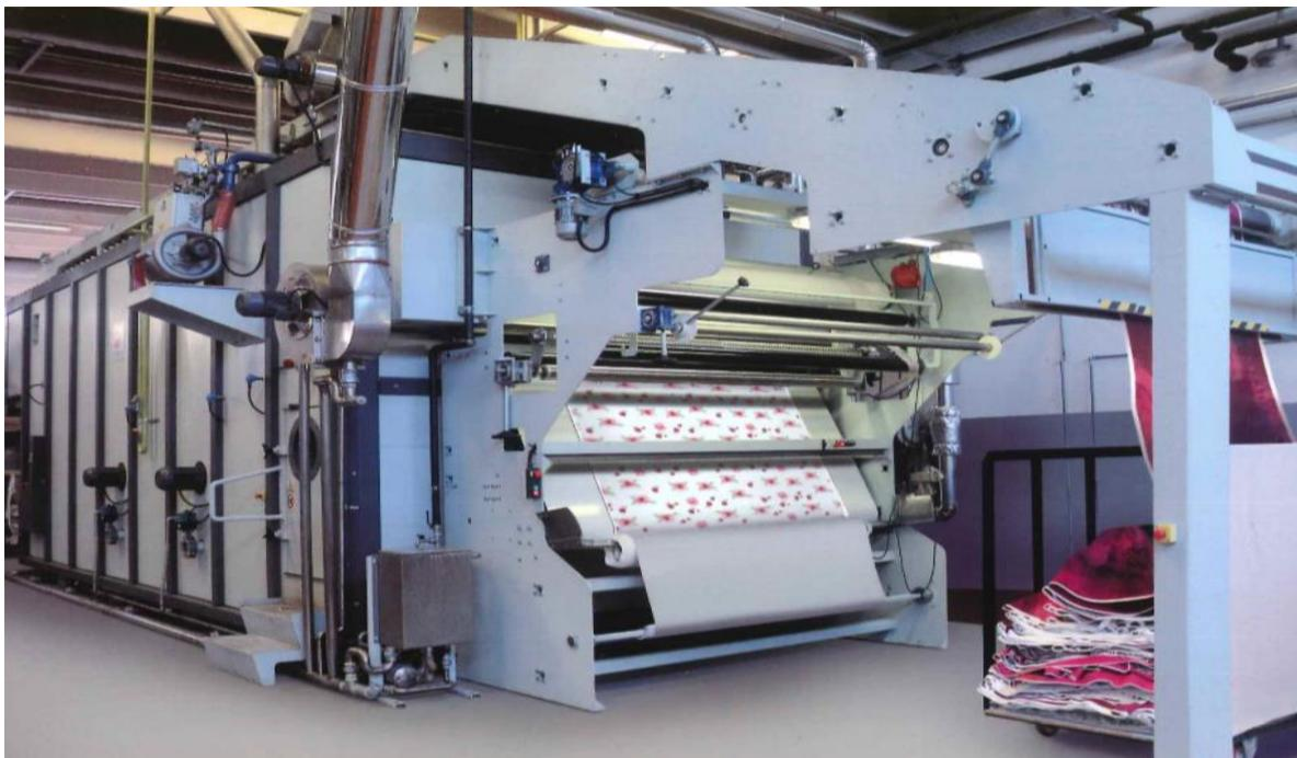
圖 5 SCR 公司將不同布料分別使用的獨立烘箱設備
