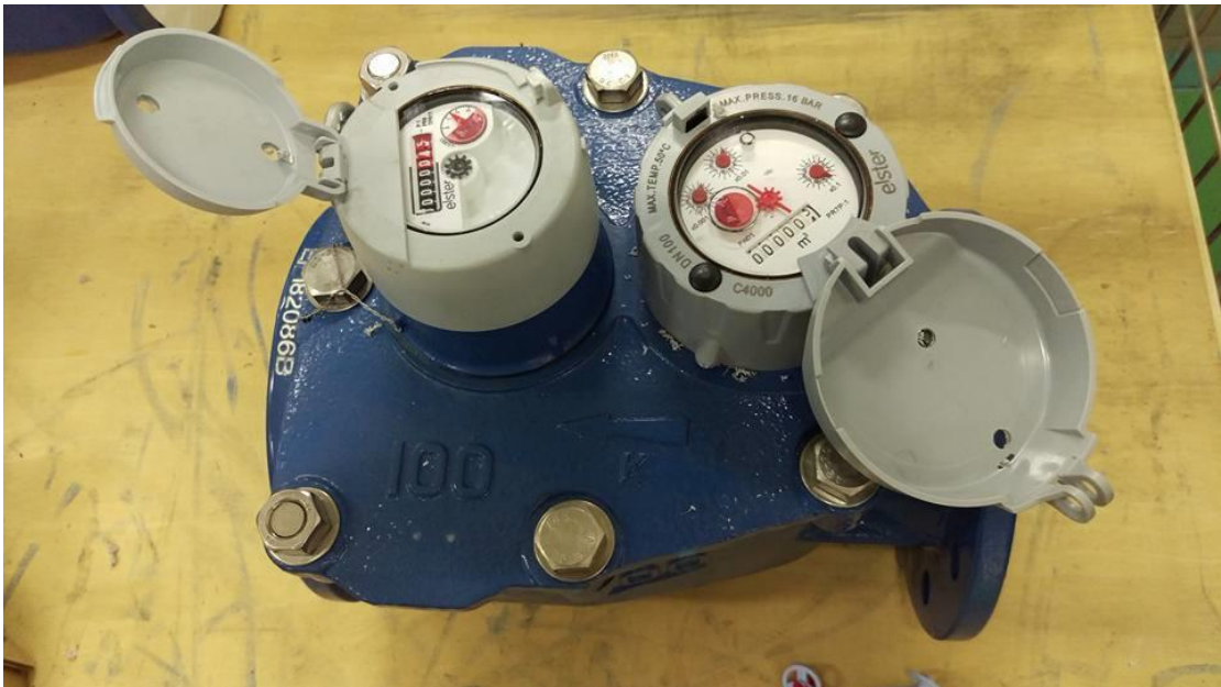
圖十二、新加坡用戶水表口徑最大者為 300 公厘，其中 50~150 公厘水表採用連結式機械表。25 公厘及以上水表一般每 10 年汰換 1 次，而用於石化及電子業的水表，則每 2 年汰換 1 次。
