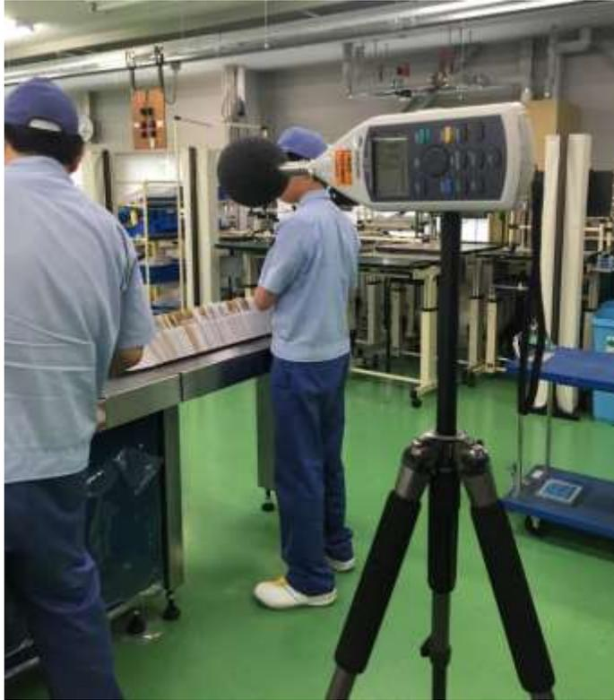
圖 5 測量末端分揀槽之噪音值
