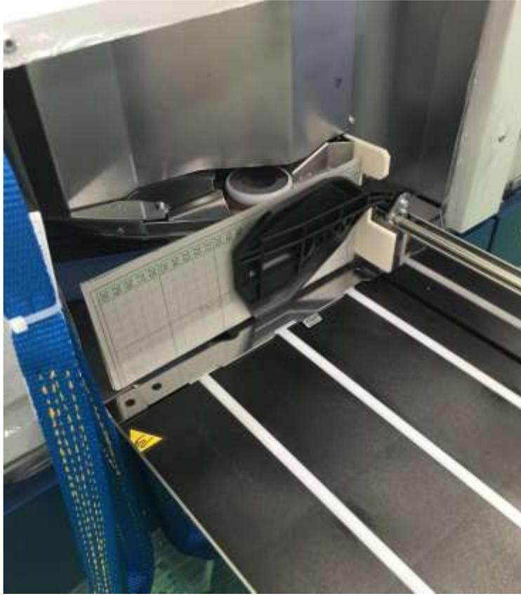
圖 11 符合可處理尺寸範圍內之測試信函成功被分揀
