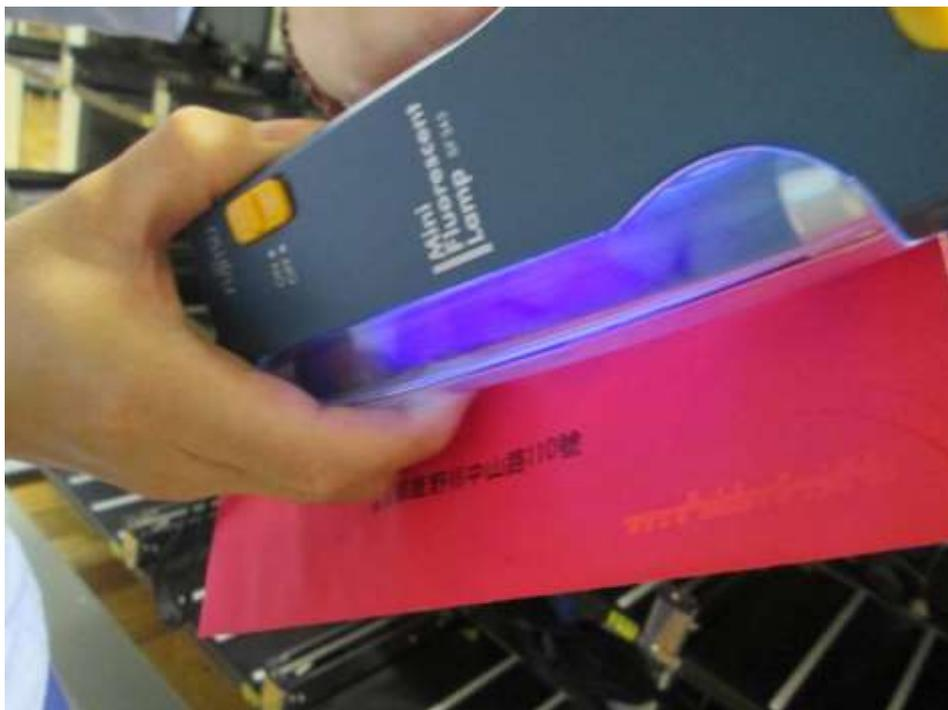
圖 26 混合不同深色背景信封做測試
