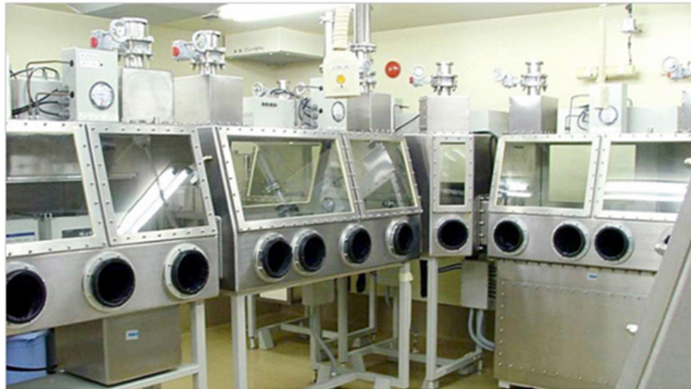
圖四、NIID 之 BSL-4 之手套箱系統(圖片來源 http://www.japanbullet.com )
