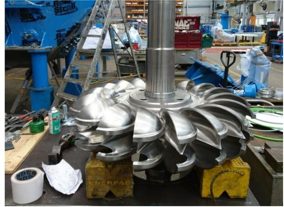
圖7：Pelton式水輪機runner
