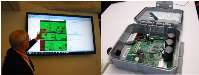
EnerNOC 已建置一個可彈性擴展、安全的技術平台，包括測量、控制、通信和全球網絡營運中心，結合 DR 管理程序，其網路操作中心(如圖表 24)(Network Operations Center, NOC)每天 24 小時傳送即時的能源資訊，相當於虛擬電廠的中樞神經系統，可迅速接受訊息並傳送給相關部門進行回應，有效協助調度電力需求接近供給，包含世界各國的需量反應操作皆由波士頓網路操作中心統一控制。此外，EnerNOC 用戶基準線(CBL)演算方法的應用，可模擬 DR 如何影響用戶的資源價值，及是否能為客戶所接受。以 EnerNOC 最常應用的「緊急方案」與「輔助服務」為例，其補償方案、衡量績效與基線選擇、執行方式如圖表 25 所示。
