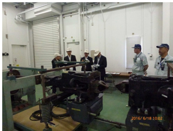
圖 3-4 列車自動連掛與解連系統測試
