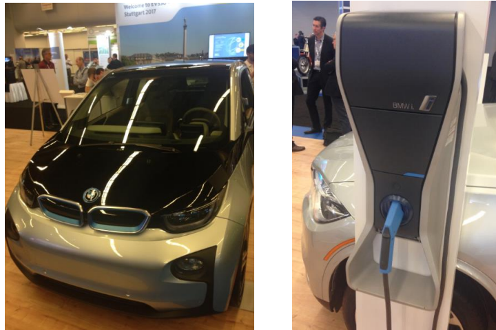
圖二、BMW i3 電動車及充電設備
