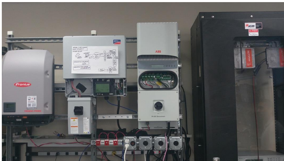
圖 9 PG&E 的智慧變流器直接利用智慧電表的通訊系統
