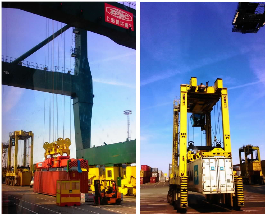
橋式機與跨載機現場作業情形，資料來源:自行拍攝
