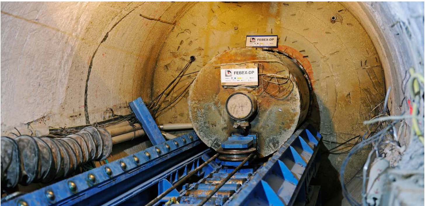
圖二十九 FEBEX 實驗最終拆除
