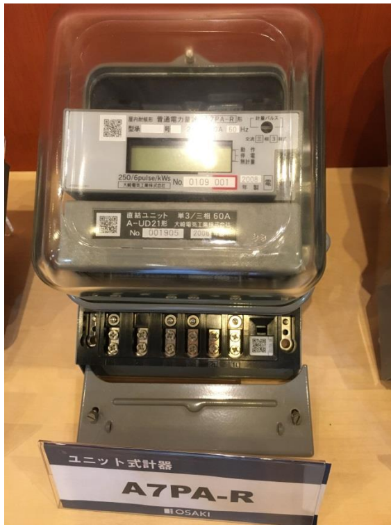
圖 14 關西電力公司智慧型電表
