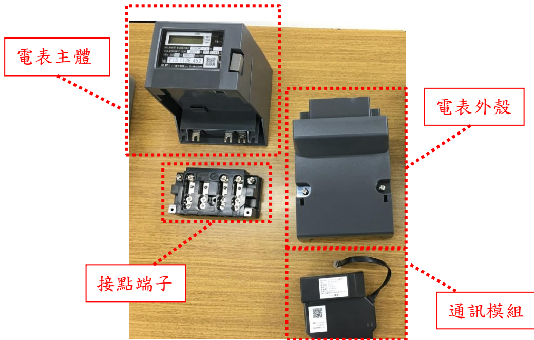
圖 28 TEPCO 設計之智慧型電表拆解圖
