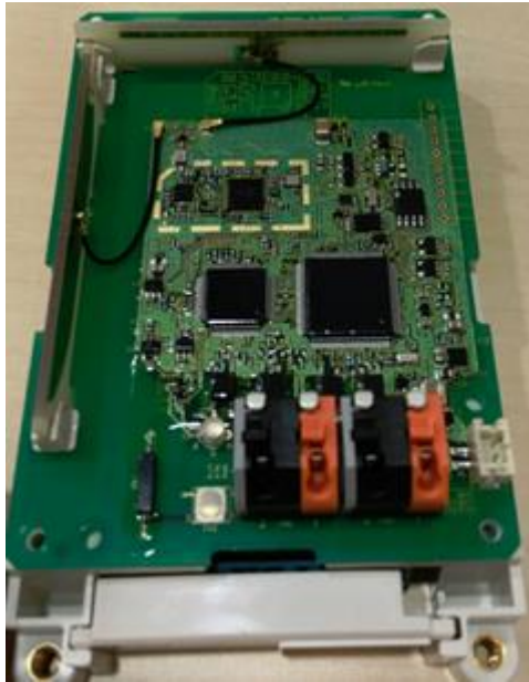
圖 10 ABiT 開發之水表專用 RF Mesh 模組
